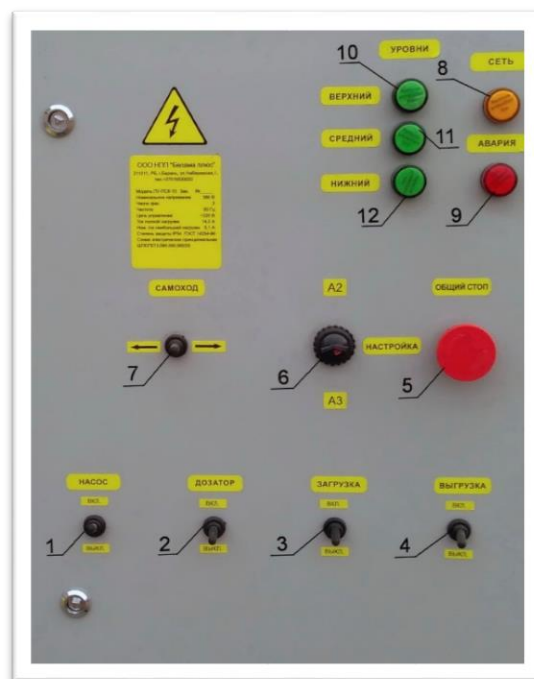
Рисунок 5.4 Панель пульта управления 1 – 4, 7 – тумблера; 5 – кнопка блокировки; 6 – переключатель автоматических режимов; 8-12 – лампочки
